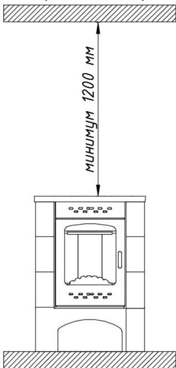
*Схема монтажа изразцовой печи-камина от потолка из негорючего материала*
