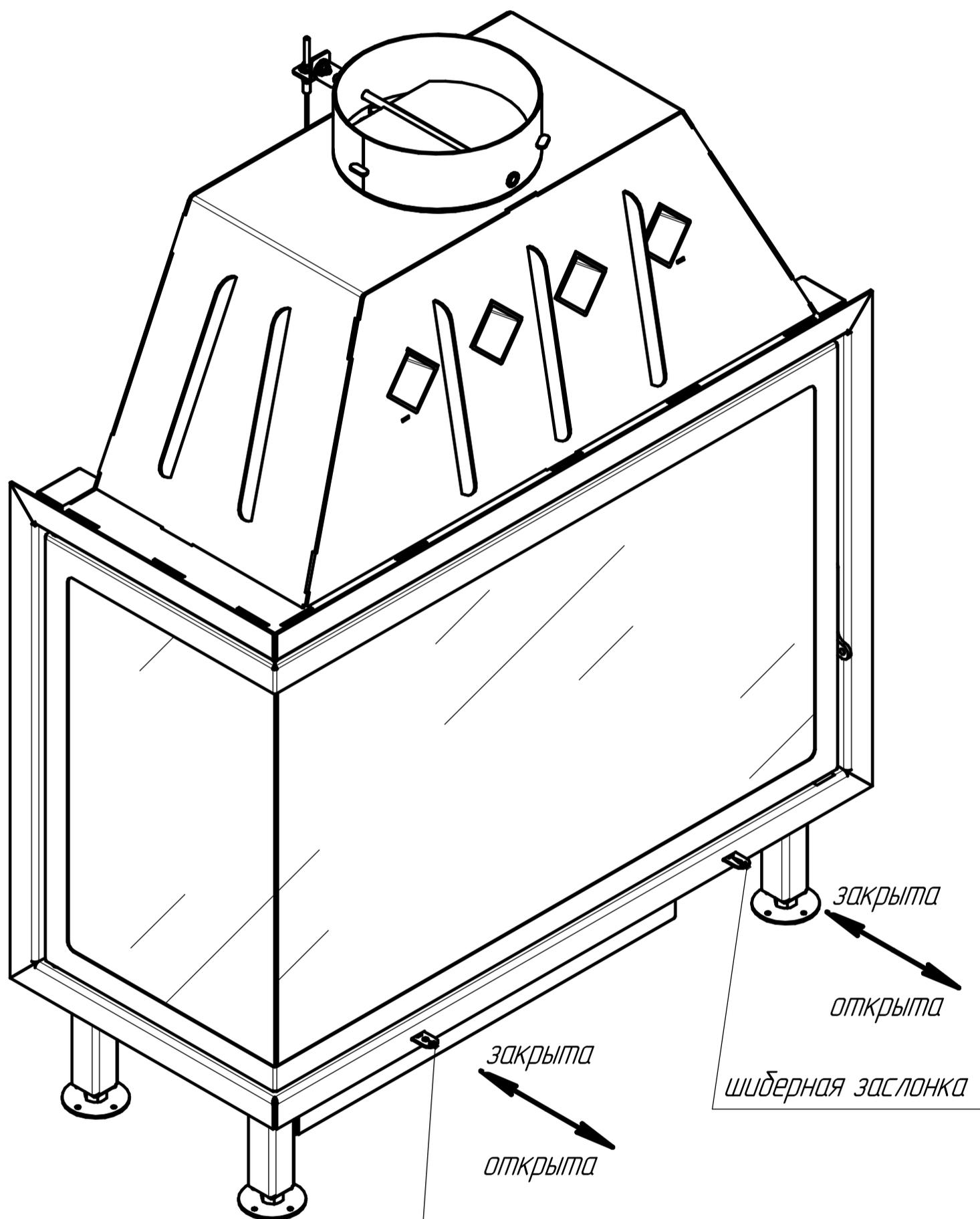
подача воздуха на горение в топочную камеру,
