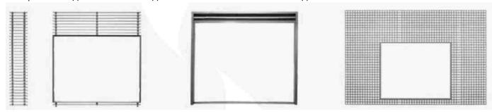
Наши кованные накладные решетки составляют легко устанавливаемую систему, которую вы можете собрать по своему вкусу и установить по бокам или сверху каминной вставки. Система включает базовый набор и несколько дополнительных решеток различной ширины. Количество и ширину дополнительных решеток следует выбирать в соответствии с размеры вашей печи. Высота составляет 550 мм для моделей 110 и 510 и 650 мм для моделей 210 и 520.
