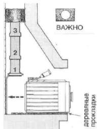
3 ВАЖНО: Тщательно уплотните пространство между верхней трубой и стенами дымоходного канала. (Иначе полезное тепло будет выходить через дымоход.) Подложите тонкие деревянные рейки под "пятки" суперкассеты и установите кассету. Смажьте клеем втулку кассеты. Задвиньте кассету так, чтобы втулка находилась под трубой.
