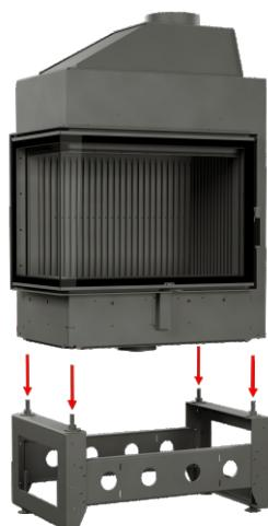
Опустите топку на подставку, с помощью гаечного ключа на 24 выкручивайте болты таким образом, чтобы добиться расстояния между топкой и подставкой 35мм.
